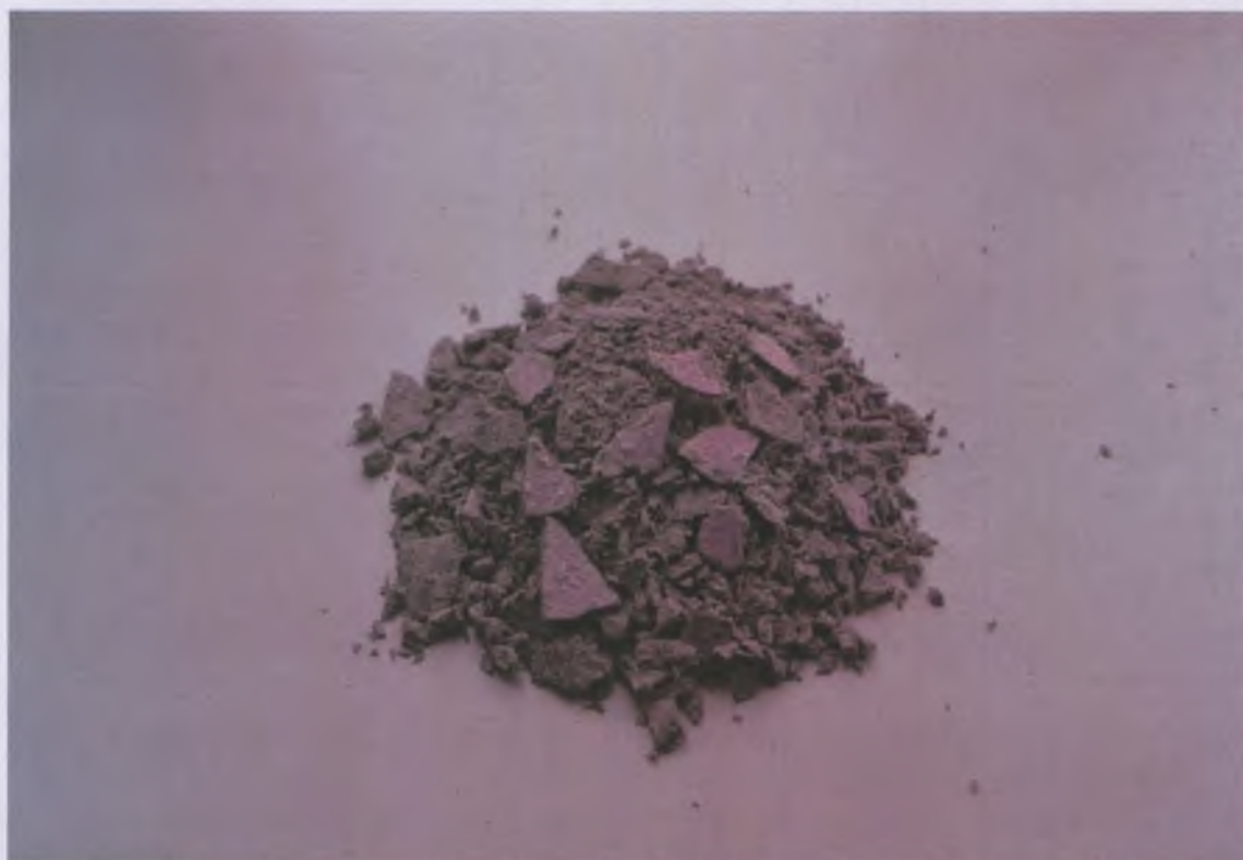
Фото 1. Образец системы полимерного защитно-декоративного покрытия до испытания. (DSC_0387. jpeg)
