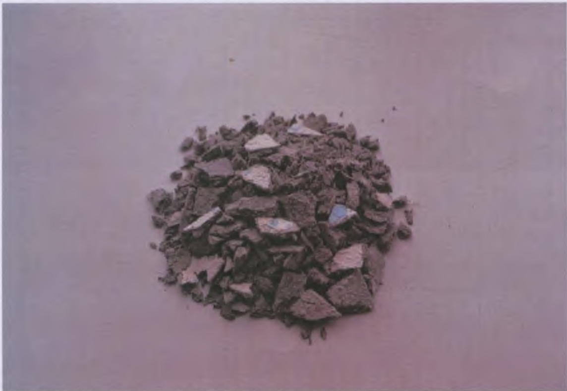
Фото 1. Образец системы полимерного защитно-декоративного покрытия до испытания. (DSC_0389. jpeg)
